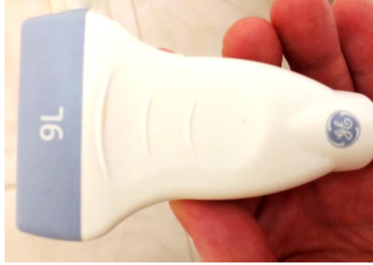
Рис. 8. Лінійний УЗД-датчик 9L, частота від 5 до 15 МГц, глибина сканування до 11 см (а, б). Використовується для дослідження поверхневих структур
