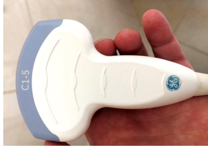
Рис. 9. Конвексний УЗД-датчик C1-5, частота від 2 до 7,5 МГц, глибина сканування до 25 см (а, б). Використовується для дослідження глибоких структур (органи черевної порожнини, заочеревинний простір тощо)
