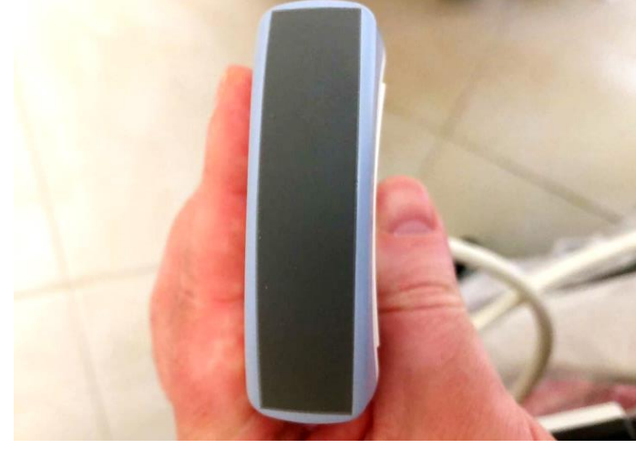
Рис. 9. Конвексний УЗД-датчик C1-5, частота від 2 до 7,5 МГц, глибина сканування до 25 см (а, б). Використовується для дослідження глибоких структур (органи черевної порожнини, заочеревинний простір тощо)
