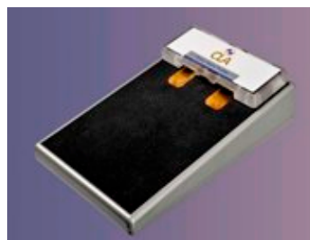
Рис. 5 Плетизмограф для вимірювання варіабельності серцевого ритму
