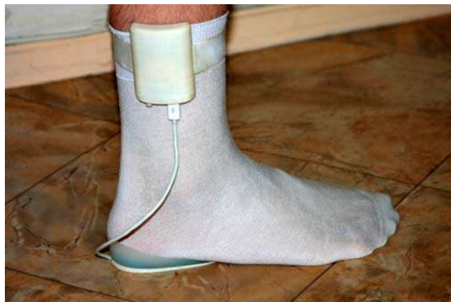
Рис. 2.17 Зовнішній вигляд пристрою для визначення навантаження на стопу
